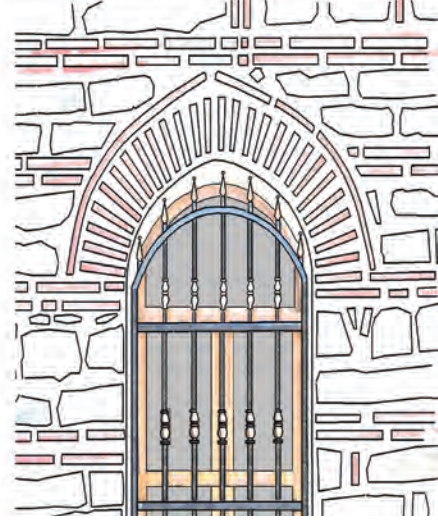
Bursa Somuncu Baba Cami revak yan duvar pencere detayı (Ö. ÇUHADAR- 2010)
